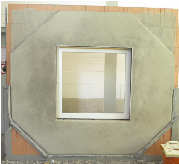
Bild 7: Ansicht des Prüfkörpers mit PHLz6-0,5 im Prüfrahmen vor den Untersuchungen
